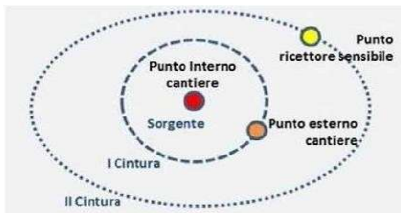
Figura 1 – Schema concettuale delle cinture di monitoraggio
